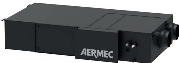
Unité de **récupération de chaleur** conçue pour une installation de type gainable horizontale dans les pièces intérieures, dotée d'un récupérateur de chaleur enthalpique à flux croisés avec efficacité de récupération supérieure à 70 %. L'échangeur permet de transférer l'énergie de l'air d'expulsion à l'air neuf en évitant le mélange direct entre les flux d'air.
