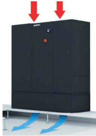
Version pour installation périmétrique à l'intérieur du Data Center. Dans ce cas, la sous-base, équipée de panneaux de fermeture latéraux, devra être installée au-dessus du plancher. Il est quand même essentiel de vérifier si la hauteur du plafond autorise une bonne aspiration d'air.
